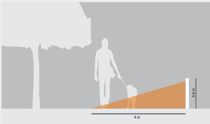
Rappresentazione laterale del fascio Bidi Bollard monoemissione Side view Bidi Bollard beam, unidirectional
