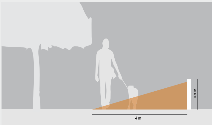
Rappresentazione laterale del fascio Bidi Bollard monoemissione Side view Bidi Bollard beam, unidirectional
